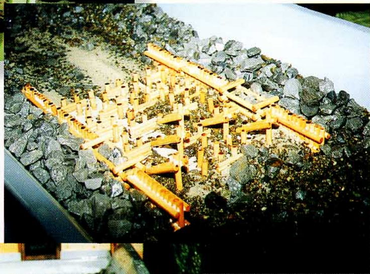
河床材の移動状況確認 ▼
