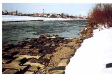
ポーラスコンクリート製根固めブロックを河川に設置し、水生昆虫の生息および藻類の付着状況を調査しています。付着藻類は、経時的に多様化しています。また、水生昆虫の生息も多く確認されています。冬期の凍結融解に対して、十分な耐久性があります。
