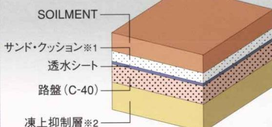
※1 雨水を浸透させる目的が損なわれるため、クッション層のモルタル使用は避けてください。
