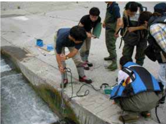
写真 - 4 三次元流速計を用いた魚道調査の状況
