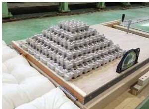
写真-3 傾斜台、堰堤状況
