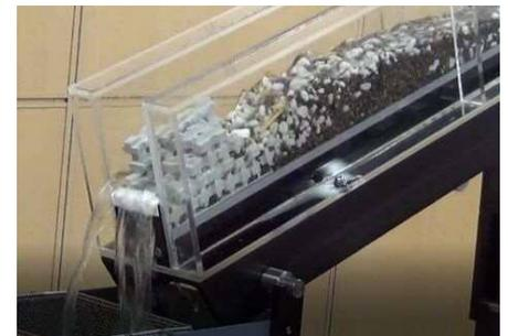
写真-7 土石流模型実験状況
