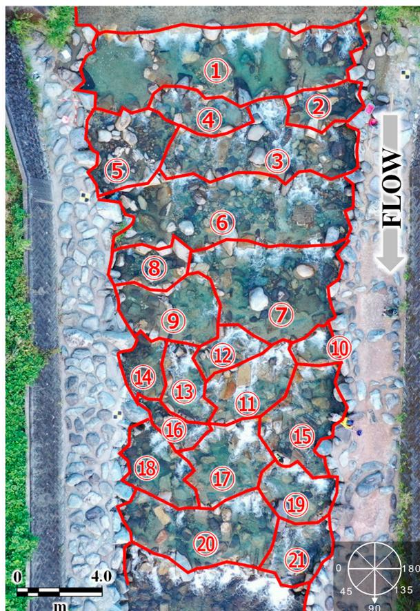
図-2 評価に用いたウロコタイプ全断面魚道
